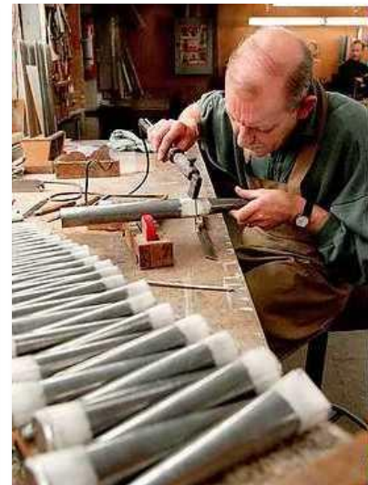
r.: dicht solderen van orgelpijpen
