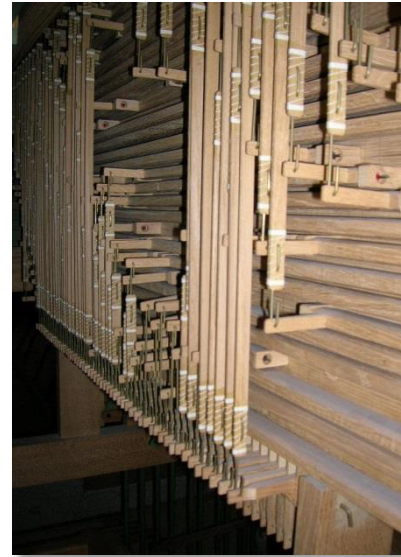
l.: windlade in de werkplaats. r.: toetsmechaniek van een orgel (let op de dunne latten: de abstracten)
