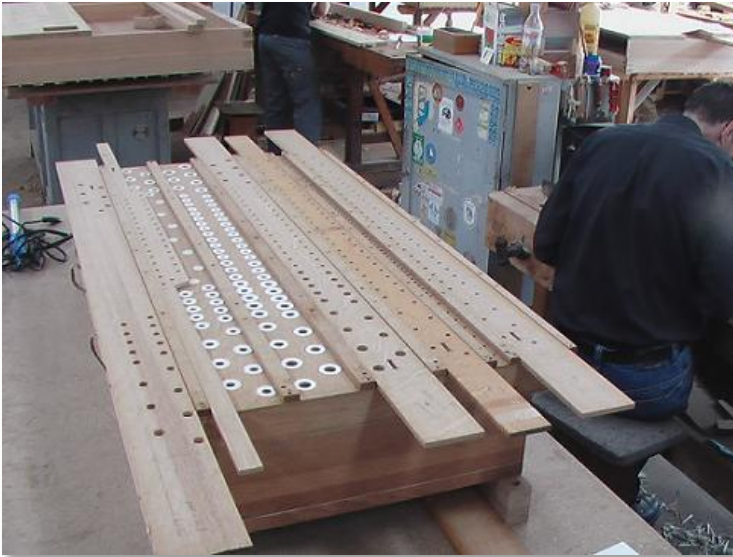
l.: windlade in de werkplaats. r.: toetsmechaniek van een orgel (let op de dunne latten: de abstracten)
