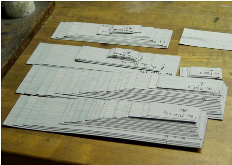
l.: uitgesneden onderdelen van metalen orgelpijpen.
